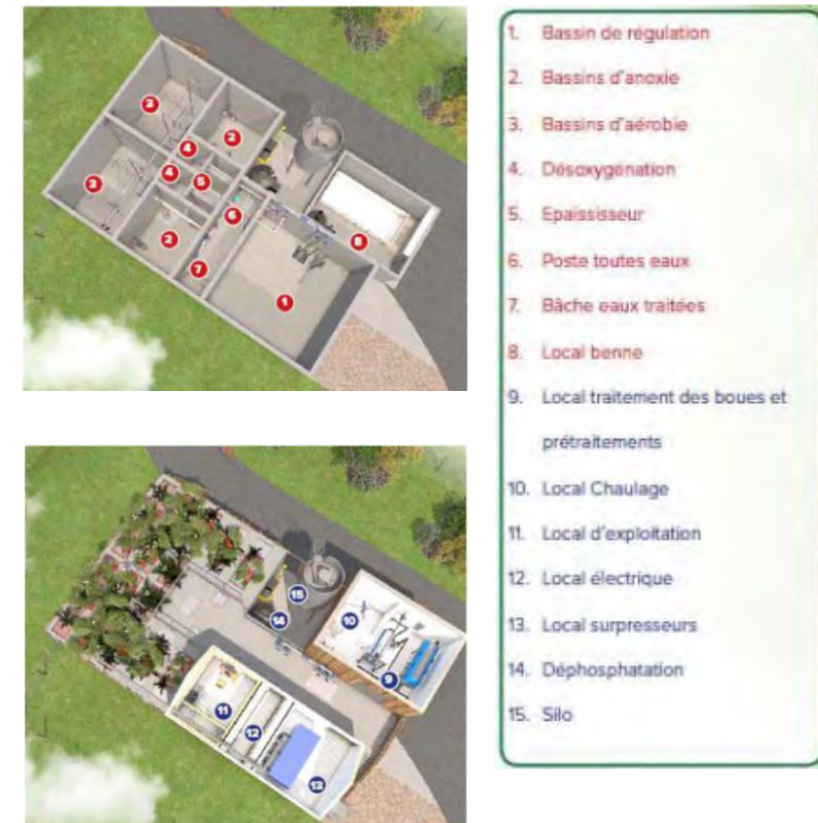
Figure 115 : Exemple de STEP Organica pour 2 000 EH. Source : Présentation MSE
